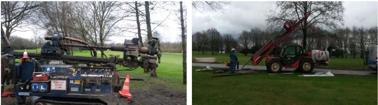
Figuur 5: Avegaarboor (links) en sonische boorstelling (rechts)
