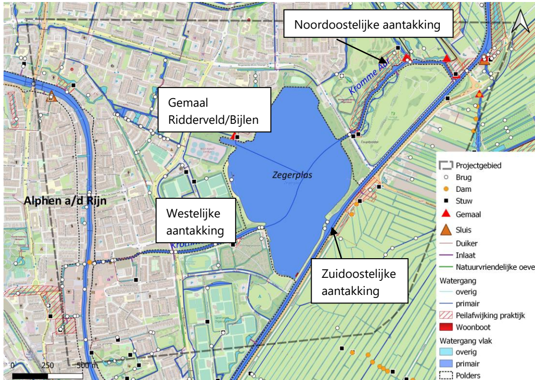
Afbeelding 1.1 Locatie en watersysteem Zegerplas
