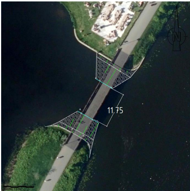
Afbeelding 5.8 Verkleinen doorstroomopening aansluiting zuidoostzijde tussen Zegerplas en Aarkanaal (ontwerptekening in bijlage II)
