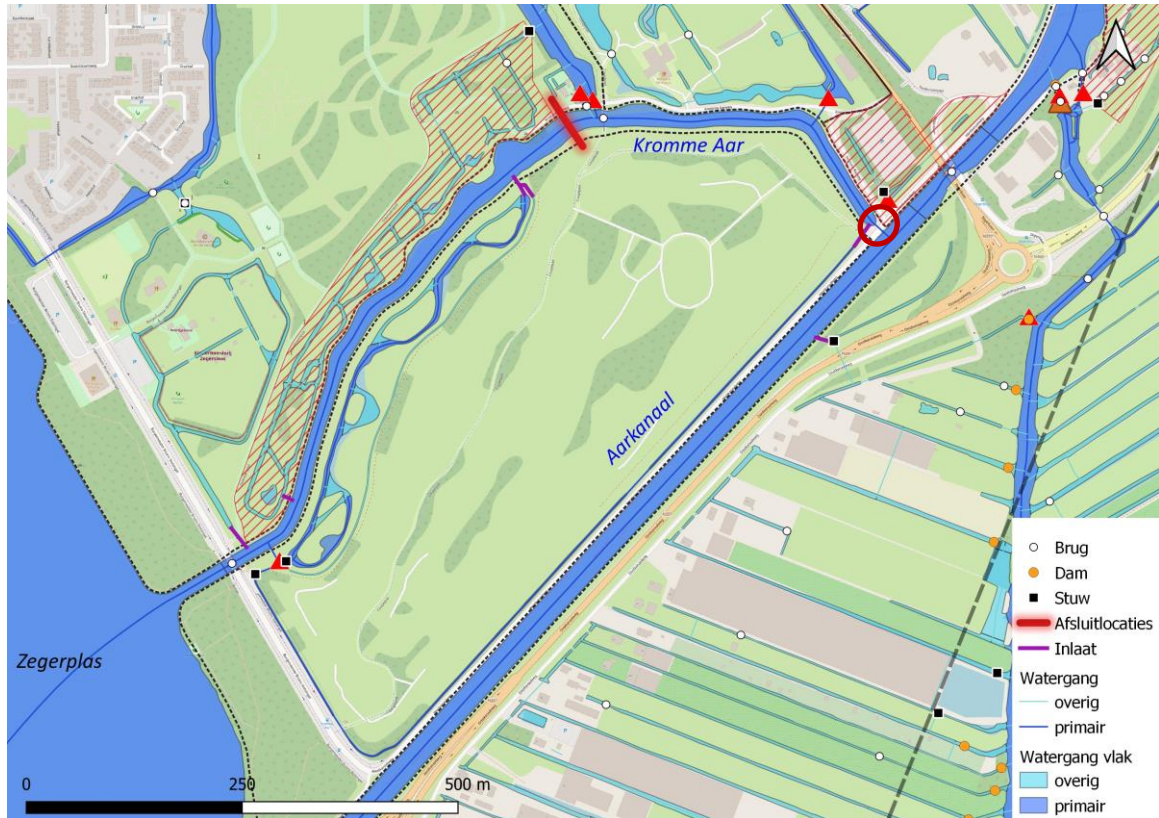
Afbeelding 5.5 Locatie afsluiting Kromme Aar oostzijde (rode streep, rode rondje is locatie her te dimensioneren duiker)
