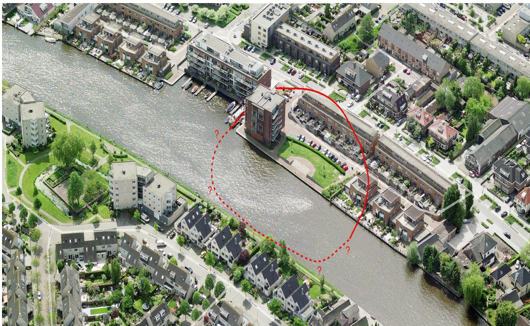
FIGUUR 5 Globale begrenzing van het gebied waarin de Holocene deklaag na het beëindigen van de sanering Fase 1 nog verontreinigd is. Bron: Nader bodem- en saneringsonderzoek, Lexmond, juni 2002.
