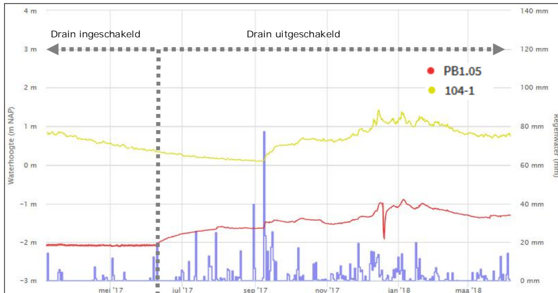
Figuur 16: Verloop grondwaterstanden in de stort nabij de ringdrain (PB1.05) en in de stort op 70 m afstand van de drain (104_1)
