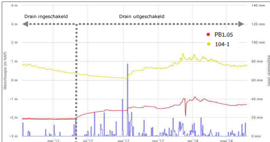
Figuur 16: Verloop grondwaterstanden in de stort nabij de ringdrain (PB1.05) en in de stort op 70 m afstand van de drain (104-1). In de figuur is op de rechter as de neerslag opgenomen.
