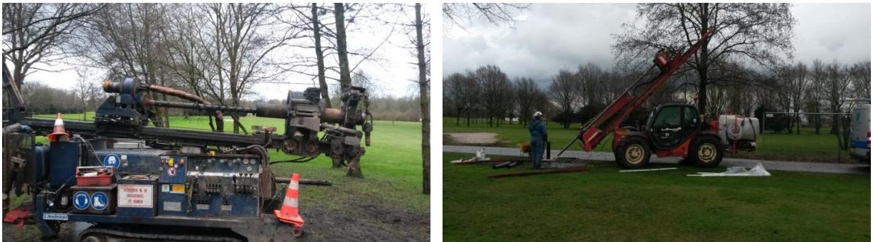
Figuur 5: Avegaarboor (links) en sonische boorstelling (rechts)
