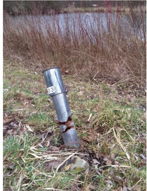
Figuur 4.2 Rijschade aan robuuste beschermkoker op afgesloten terrein en maaischade
