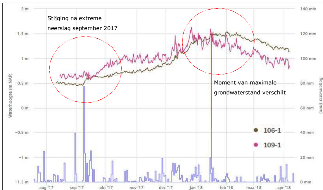
Figuur 14: Verloop grondwaterstanden en neerslag voor peilbuizen 106_1 en 109_1 (in stortmateriaal)
