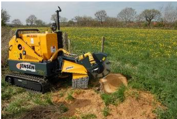
Afbeelding 45: voorbeeld van een stobbenfrees op een mobiele kraan op
