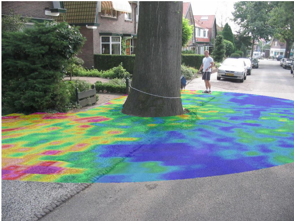
Afbeelding 26: projectie van een grondradarmeting op een diepte van 60 cm. De reflectiesterkte gaat van blauw (zwak, bijvoorbeeld zand) tot paars (sterk, bijvoorbeeld funderingen of een put). Wortelreflecties worden hier in de tinten groen tot geelgroen
