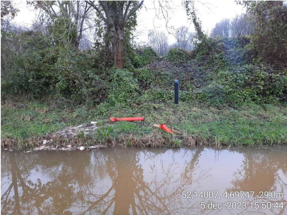
Figuur 1: situatie bij peilbuis PB1.09 waar water uit de peilbuis over het maaiveld afstroomt naar de ringsloot
